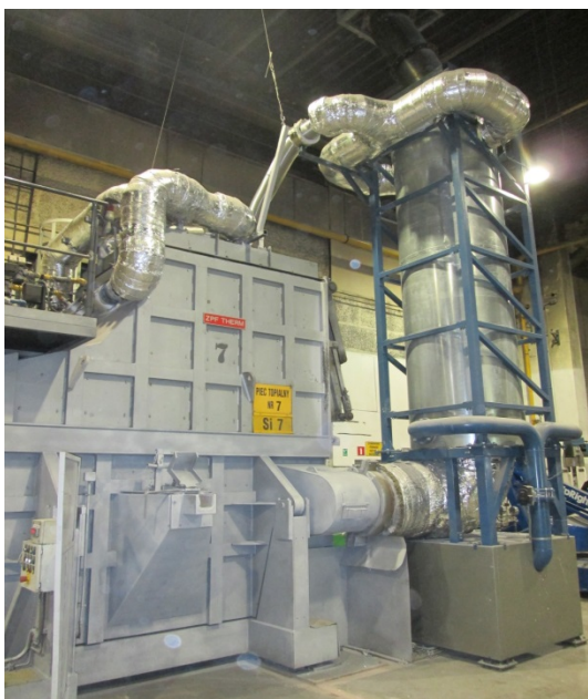
Tavící pec 7 s rekuperátorem
