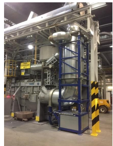
Rekuperator am Späneofen, Polen
